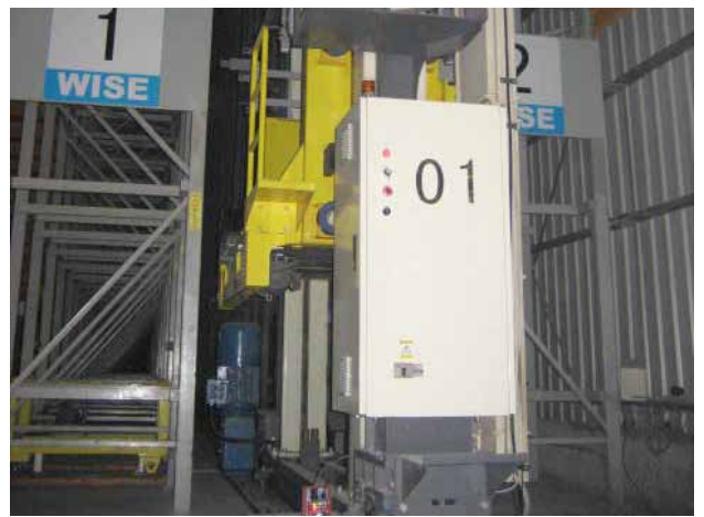
LT30 巷道堆垛机光学定位
